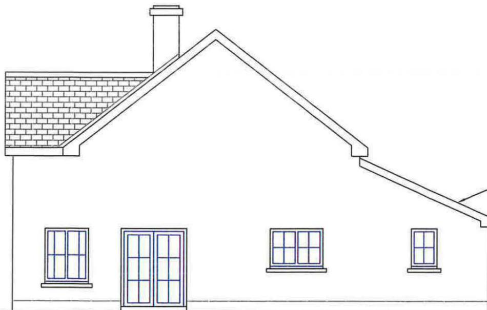
*EXISTING END ELEVATION (SOUTH-EAST). SCALE: 1 : 100.*
